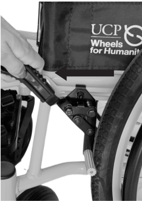
Figura 1. Freno de rueda - bloqueado
