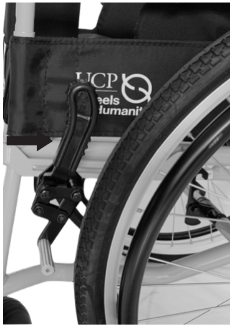
Figura 2. Freno de rueda - desbloqueado
