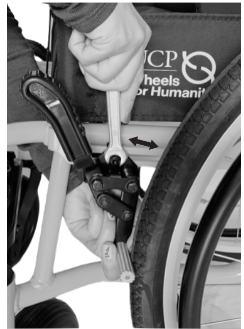
Figura 3. Ajuste de los frenos de las ruedas.
